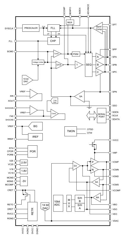
FIG. 1 - BLOCK DIAGRAM OF SPINDLE/VCM
